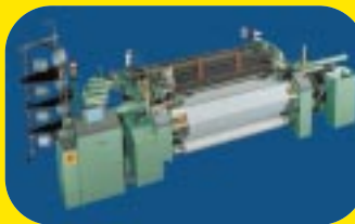
Machine à tisser dornier (source : construction)
